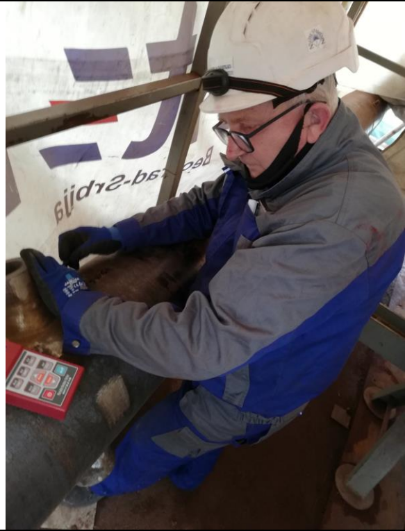
Merenje tvrdoće na zavarenim spojevima
