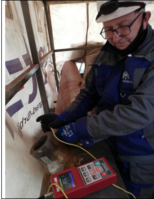
Merenje tvrdoće na zavarenim spojevima
